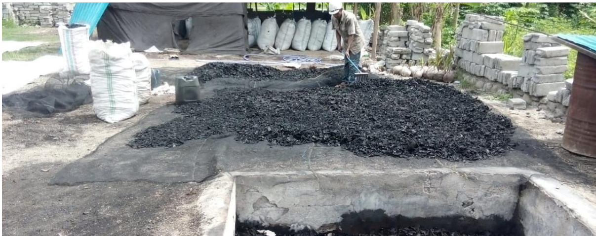
Gambar 26. Pengolahan arang tempurung kelapa di Desa Sambo, Kecamatan Dolo Selatan, Kabupaten Sigi (Kapasitas produksi 1,82 ton/hari dengan jumlah operasi 20 hari dalam 1 bulan, dengan harga jual arang tempurung Rp. 5.500/kg)
