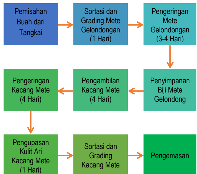
Gambar 17. Proses Pengolahan Kacang Mete
